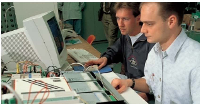
Studenten am Prüfstand zur Untersuchung feldbusfähiger Pulswechselrichter mit Steuereinheit zur Programmierung, der von der Fördergesellschaft mitfinanziert wurde.
